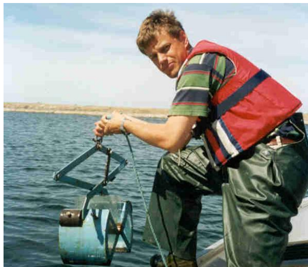
Figur 5. Modifierad ponarhämtare redo att firas ned.
